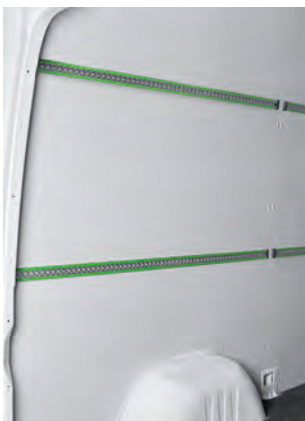
bott vario protect Innenwandverkleidungen mit integrierten Ladungssicherungsschienen.
